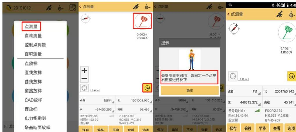
（若根据提示左右摇摆主机仍未播报“倾斜测量可用”时，则让主机居中状态下静置 5 秒钟，再摇晃主机，提示“倾斜测量可用”后即可进行测量工作）
