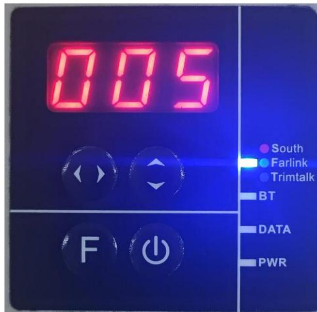
(3) 点击“启动”启动基站，当主机和电台数据链灯（1 秒 1 闪）正常闪烁时，表示基站已正常工作。
