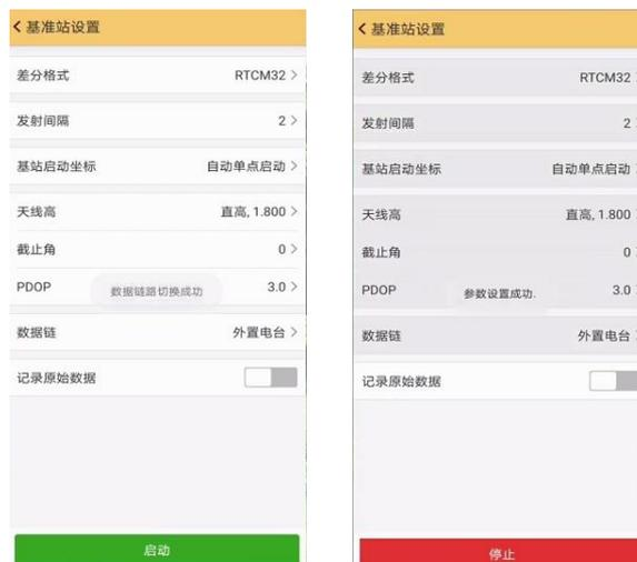
注意：第一次启动基站成功后，以后作业如果不改变配置可直接打开基准站，主机即可自动启动发射。
