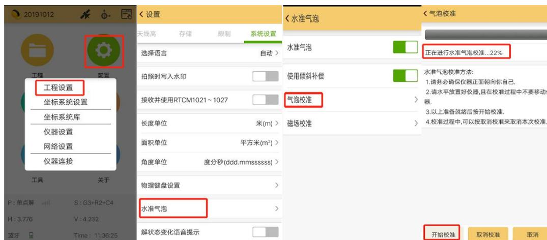
[为保证惯导精度，测量作业前若更换过对中杆或者更换过工作区域（跨省），建议重新对气泡进行校准，避免因对中杆弯曲变形或者温度、气压、重力变化等影响测量精度。]
